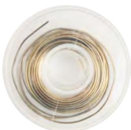
Contiene il 50% di argento, senza cadmio, morbida, si scioglie facilmente, Ø del filo .025", temperatura di fusione 650°C/1220°F. Matassina da 2 m
