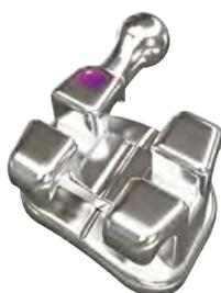
Attacchi diretti. Creati con tecnologia MIM (Metal Injection Molding) che permette di realizzare attacchi estremamente precisi che migliorano l'efficienza del trattamento. Design a basso profilo per migliorare l'estetica e il comfort del paziente, i ganci sono angolati a 15° per ridurre le interferenze con il tessuto gengivale. Base anatomica ritentiva 80 Mesh. Confezione da 20 pz.
