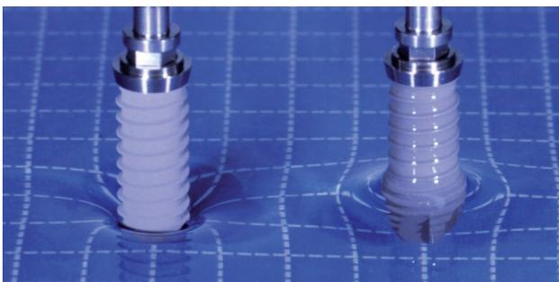
Esperimento di bagnatura con un impianto ELEMENT con superficie non condizionata (sinistra) e INICELL® (destra).
