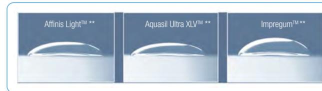
\* Test comparativo effettuato da Kettenbach, angolo di contatto misurato con lo strumento di misurazione DAS 100, Kruss, 2006. Valutato con il metodo di fitting circolare.
