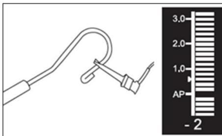
2. In modalità combinata motore e rilevatore apicale, toccare il gancio labiale con il file e controllare che tutte le barre indicatrici siano illuminate, come mostrato di seguito:
